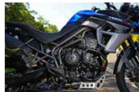
Motor tricilíndrico de 800cc e 95 cv recebeu melhorias internas e novo câmbio
