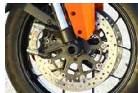
Para frear essa “Fera” dois discos flutuantes de 320 mm com pinças radiais Brembo e ABS desligável
