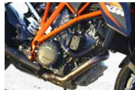
Motor V2 de 1301 cm³ é DOHC com oito válvulas e refrigeração líquida: produz 180 cv a 8.870 rpm
