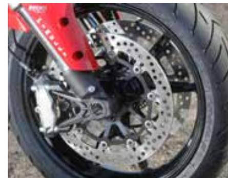
Na dianteira, disco duplo com fixação radial e sistema ABS de última geração
