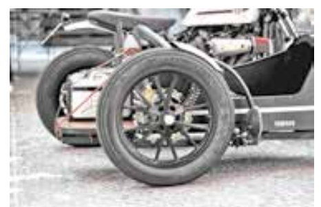
A roda que equipa o sidecar é a mesma utilizada na dianteira da moto, de 19 polegadas
