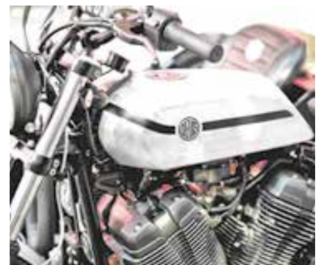
O modelo personalizado pela milanese Deus ganhou tanque de combustível em alumínio
