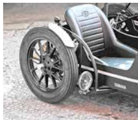
Revestido em couro, o assento do sidecar é uma peça de confecção artesanal
