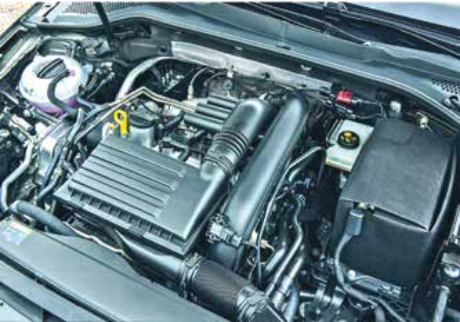
O Golf Variant é equipado com o motor 1.4l TSI BlueMotion Technology com potência de 140 cv
