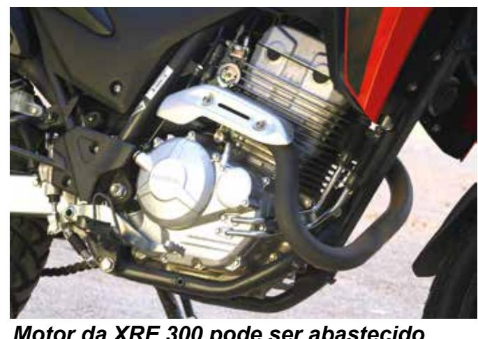
**Motor da XRE 300 pode ser abastecido com gasolina ou etanol, vantagem sobre a Ténéré 250**
