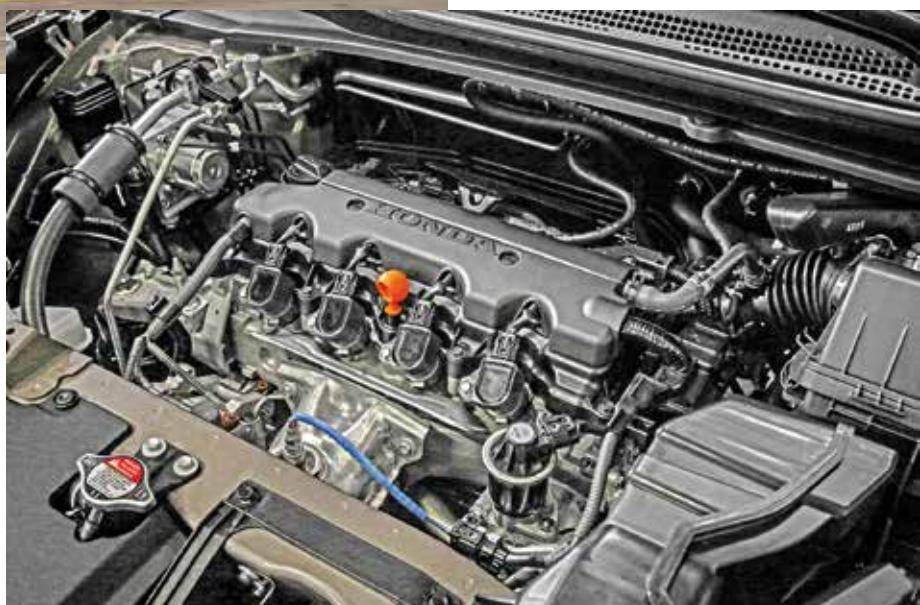
**O propulsor i-VTEC 1.8 SOHC, que adota o moderno sistema FlexOne**
