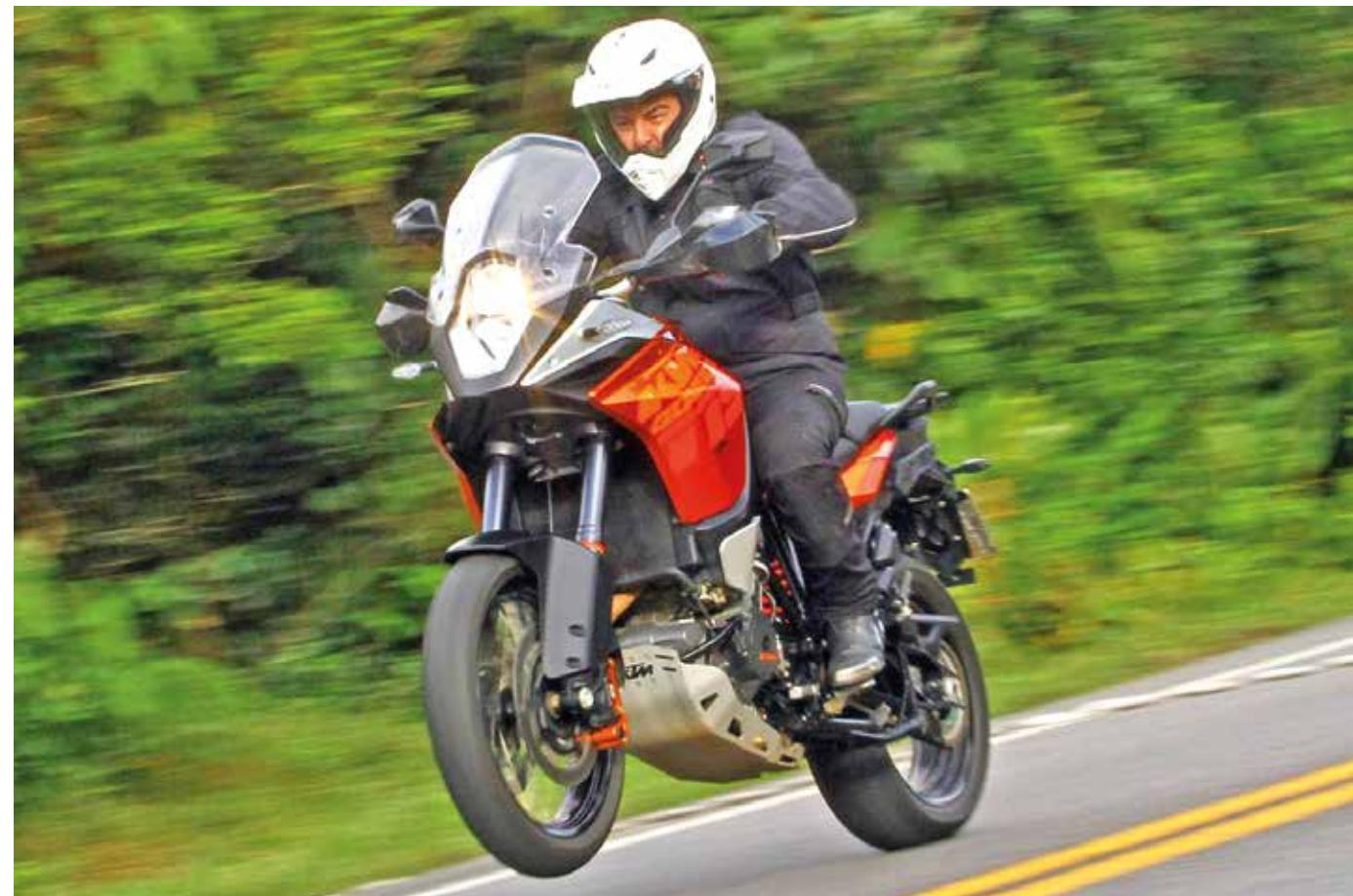
1190. Adotou também uma construção diferenciada nas rodas com aros de alumínio e raios centrais que permitem o uso de pneus sem câmara. O novo conjunto melhorou e muito a agilidade do modelo no asfalto sem comprometer a distância livre do solo (22 cm) e ainda permitiu o uso de pneus radiais, nas medidas 120/70 ZR 19 e 170/60 ZR 17 para atacar curvas com confiança.
